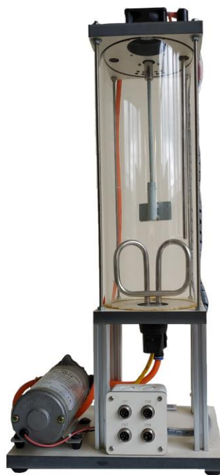
Hình 5. Module thực hành sử dụng bộ điều khiển nhiệt độ Autonics TC4S
