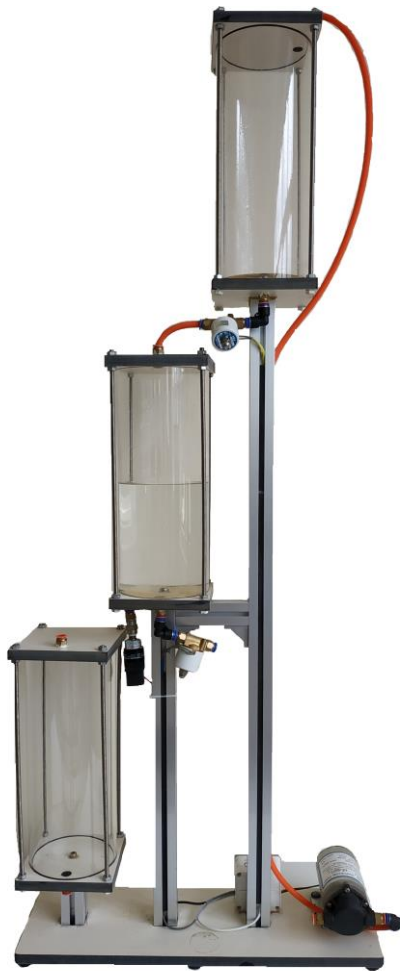
Hình 6. Module thực hành sử dụng cảm biến áp suất Sensys PTCH0001BCIA
